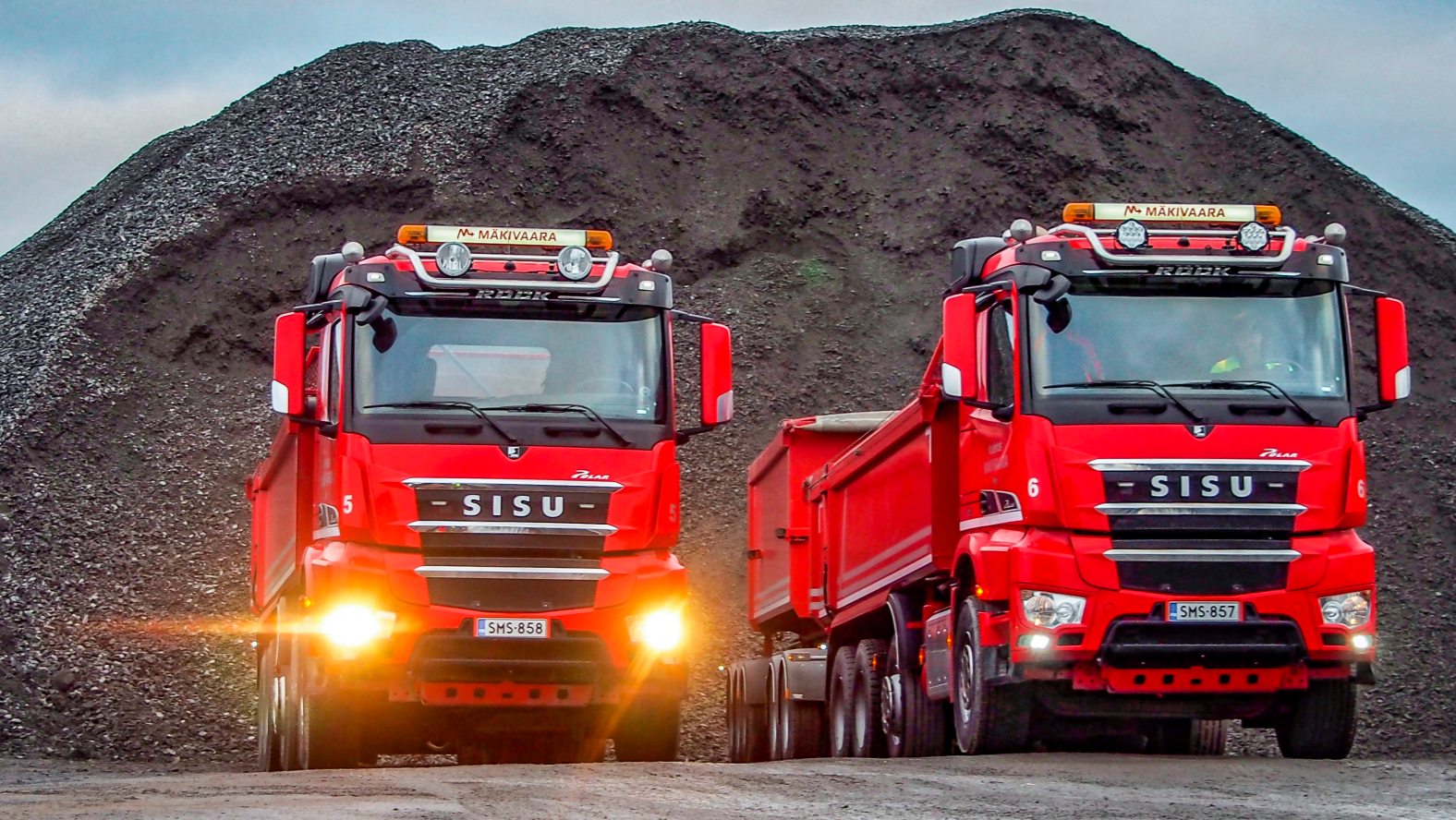
Kuljetus Mäkivaara Oy:n uusien Sisu Polar sorakasettiyhdistelmien voimanlähteiksi valittiin teholtaan 578 hv moottorit. Vaihteistot ovat automatisoituja, 16-vaihteisia PowerShift 3:ia.
